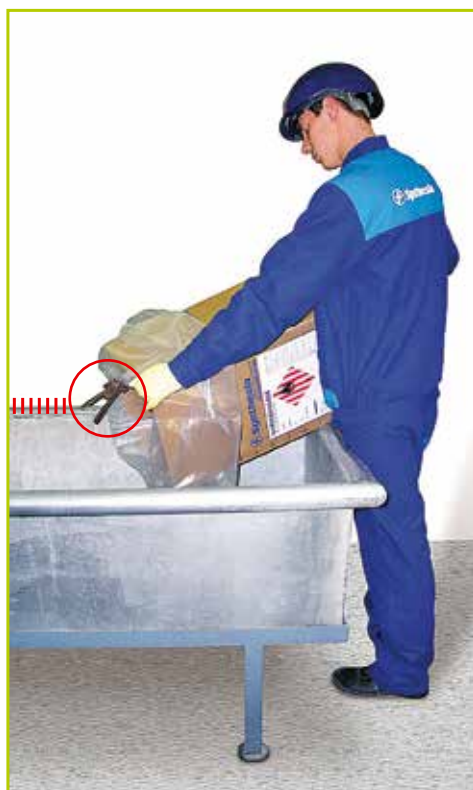
Заземление картонных коробок помощью клеммы заземления (Рисунок 1)
